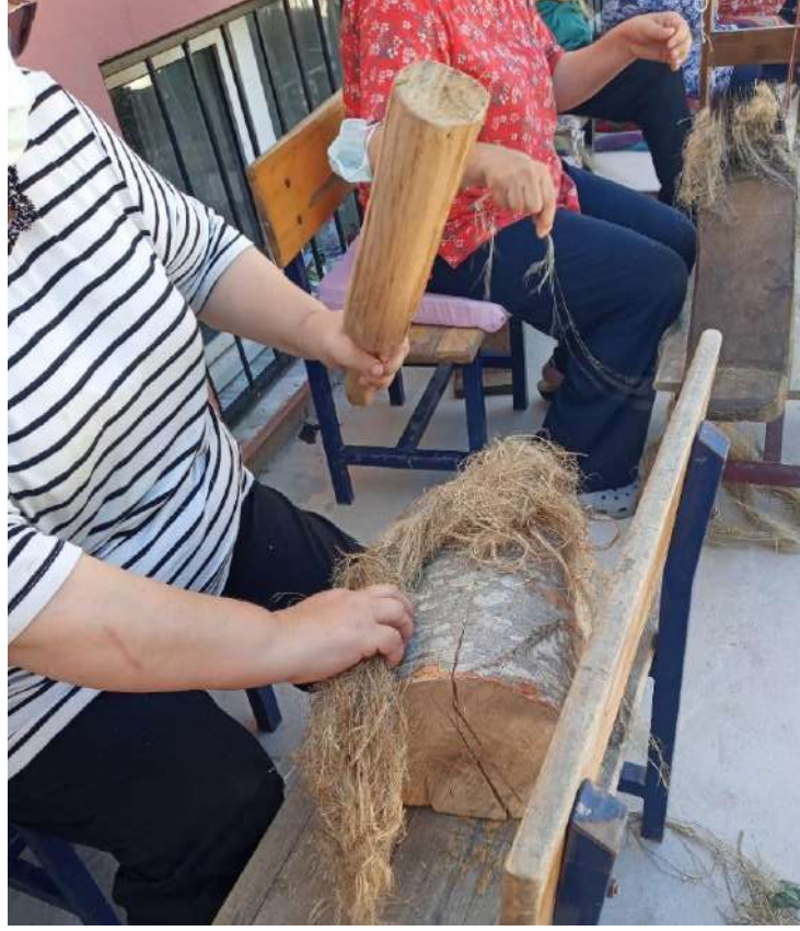
Fotoğraf 1.5: Keten Bitkisinin Tokmak Aleti ile Dvme İřlemi , Ayancık Halk Eđitim Merkezi ve Akřam Sanat Okulu Keten Evi (C. Toprak 01.07.2021).
