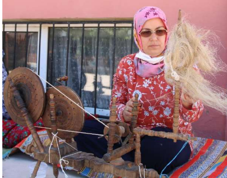
Fotoğraf 1.8: Çıkık Aleti İle Keten Elyafını Eğirme İşlemi, Ayancık Halk Eğitim Merkezi ve Akşam Sanat Okulu Keten Evi (C. Toprak 01.07.2021).
