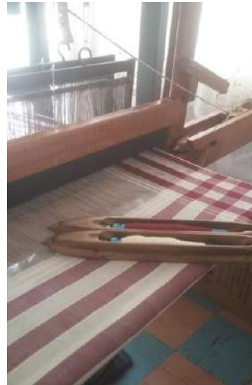
Fotoğraf 6. 2. Aşama: Aralarına Dörder Fitil Atılarak Beyaz İplikten Bezayağı Dokuma ile İki Şerit Atılması Üç Makam Rengi İki Beyaz ve Aralarına Fitil Atılarak Tamamlanması
