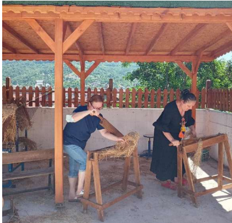
Fotoğraf 1.4: Keten Bitkisini Mengenez Aleti ile Dövme İşlemi, Ayancık Halk Eğitim Merkezi ve Akşam Sanat Okulu Keten Evi (C. Toprak 01.07.2021).
