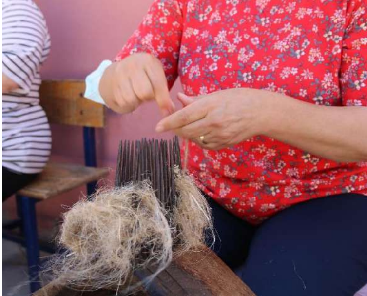
Fotoğraf 1.6: Keten Elyafının Tarak Aleti İle Tarama İřlemi , Ayancık Halk Eđitim Merkezi ve Akřam Sanat Okulu Keten Evi (C. Toprak 01.07.2021).
