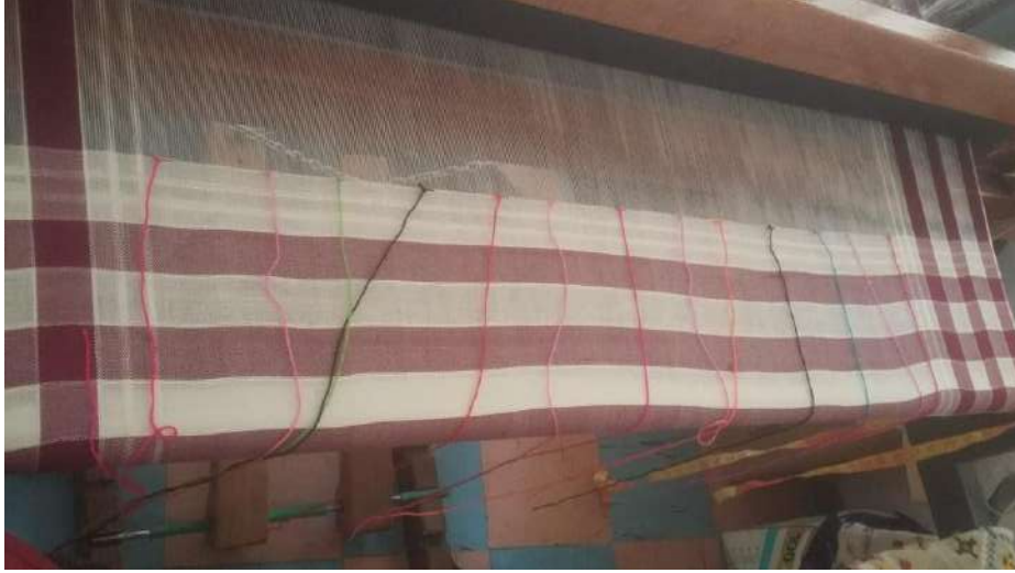
Fotoęraf 7. 3.Ařama: Renk Uyumu Dâhilinde İplikler Sayılarak Yapılacak Örneęin Yerleřtirilmesi
