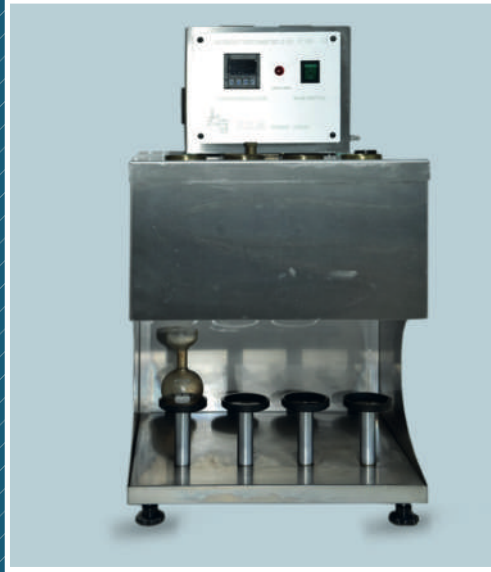
SDM Torino 180/4 Saybolt Viskozite Cihazı
