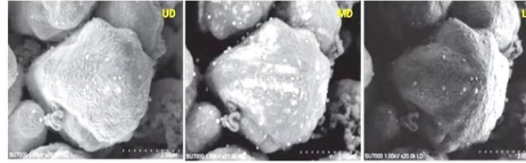
Yüzey mikro-yapısal bilgileri (UD), yüzey kaplaması (MD) ve genel topografik bilgiler (LD) için eş zamanlı görüntü edinimi. Yapılan Analizler
